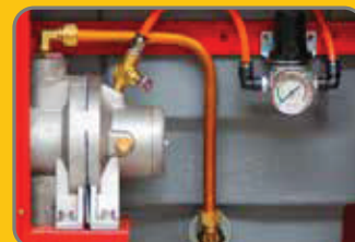
Detail van membraanpomp en drukregelaar.
