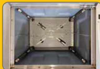
Bovenaanzicht van de spoelbak met 2 houders voor verfpistolen en 2 voor verbekers.
